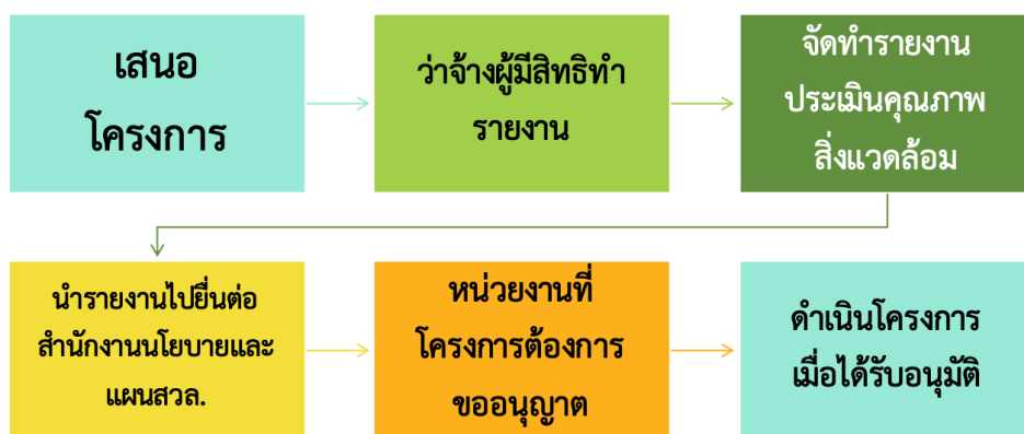
รูปที่ 6.3 ผังสรุปขั้นตอนการทำรายงานการวิเคราะห์ผลกระทบสิ่งแวดล้อม
