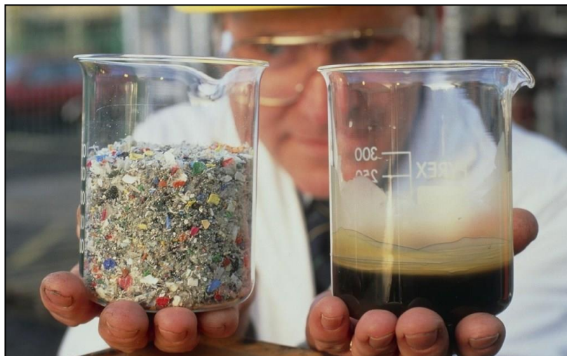
รูปที่ 4.20 การเปลี่ยนพลาสติกเป็นพลังงานเชื้อเพลิง
