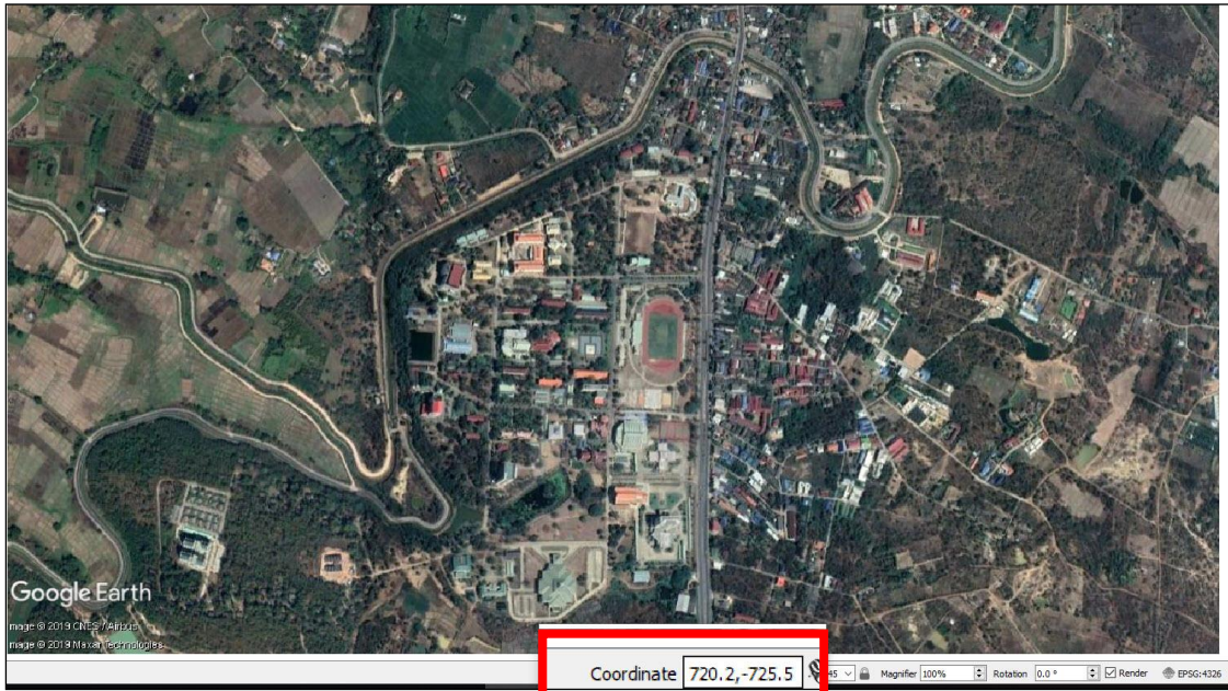
ภาพที่ 6.3 ภาพถ่ายทางอากาศที่ไม่มีการอ้างอิงพิกัดจากการทำการอ้างอิงบนโปรแกรม QGIS
