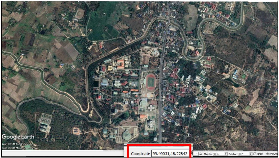
ภาพที่ 6.4 ภาพถ่ายทางอากาศที่มีการอ้างอิงพิกัดจากการทำการอ้างอิงบนโปรแกรม QGIS (แหล่งที่มา: จัดทำโดยผู้เขียน)
