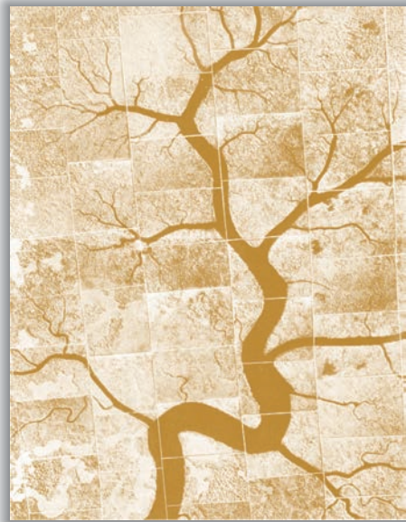
ตัวอย่าง การโมเสกรูปถ่ายทางอากาศบริเวณตอนต้นแม่น้ำราชัง ในรัฐซาราก ประเทศมาเลเซีย ที่มีการตัดต่อภาพแล้วนำมาประกอบกัน
